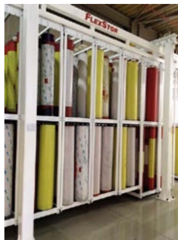
Druck-, Adapter- und Rasterwalzen-Sleeves im Flexodruck sind hochpräzise und empfindliche Werkzeuge, die sachgerecht gelagert werden müssen
